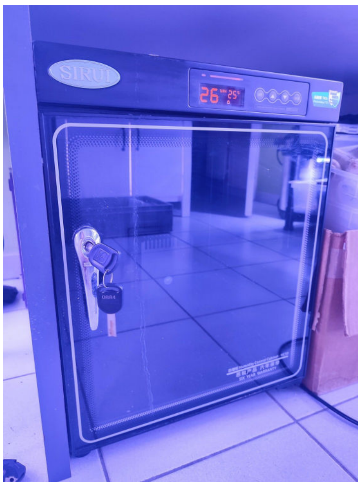
Le SIRUI HC-40 que j'utilise pour sécher le pollen, l'écran indique 26 % d'humidité et 25°C.
